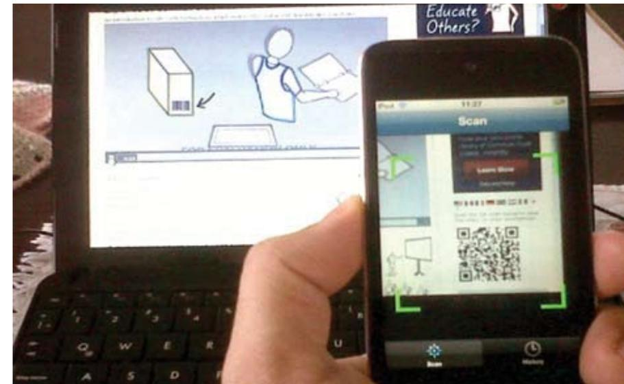
CÓDIGO QR > DISPOSITIVO MÓVIL CON WEBCAM + SOFTWARE > CONEXIÓN A INTERNET REDIRECCIONANDO A URL
